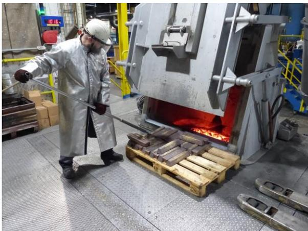
*Immagine 1: I lingotti realizzati con la nuova lega di bronzo vengono introdotti nel forno di fusione. Il materiale fuso può successivamente essere versato nel forno di colata.*
