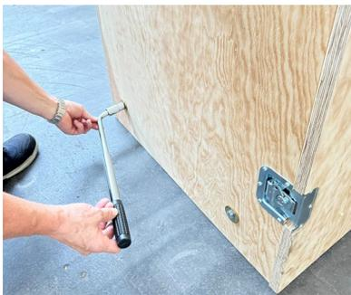
Lösen Sie jeweils auf beiden Seiten die zwei Schrauben im unteren Bereich der Transportbox. Diese sind für die Arretierung des Schrankes mit der Transportbox.
