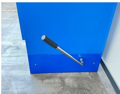
Sur le côté droit de l'armoire se trouve un trou avec une vis à six pans. À l'aide de la clé de levage fournie (uniquement avec celle-ci), vous pouvez alors sortir les roulettes dans le sens des aiguilles d'une montre afin de placer l'armoire.
