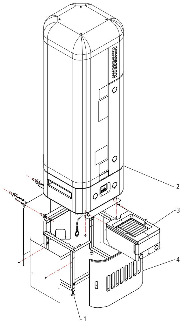
Abb. 1: 68030 Wärmepumpen-Wassererwärmer Aquapro-Ecotherma, freistehend
