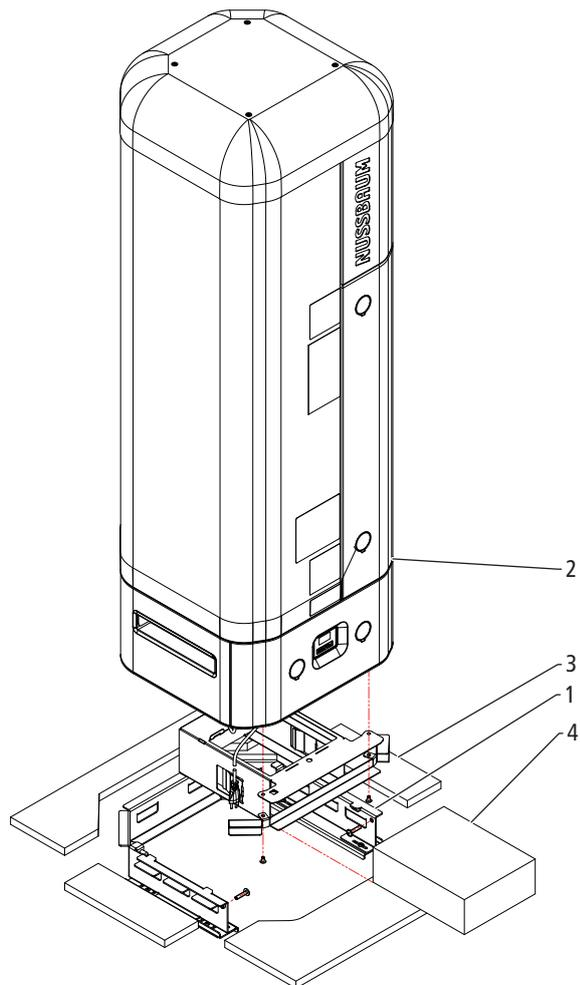
Abb. 4: 68020.22 Austauschgerät für Schrankeinbau, mit Aufsatz für Fremdgestell
