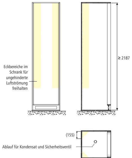
Abb. 7: Aufstellbedingungen für Austauschgerät, mit Nussbaum Unterbau
