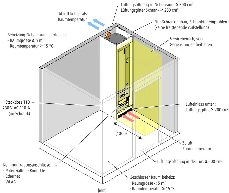
Abb. 10: Aufstellbedingungen für Geräteinstallation in kleinen Räumen
