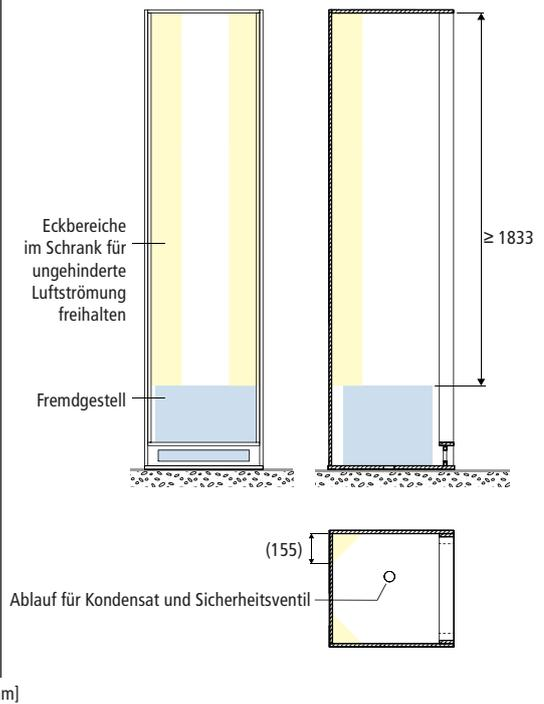
Abb. 8: Aufstellbedingungen für Austauschgerät, mit Aufsatz für Fremdgestell
