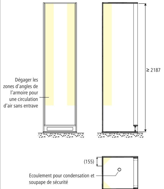
Fig. 2: Conditions de pose pour appareil de remplacement, avec soubassement Nussbaum
