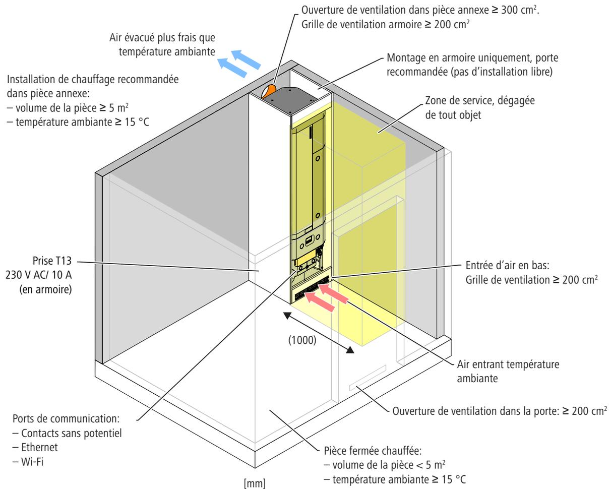
Fig. 4: Conditions de pose pour l'installation de l'appareil dans des petits locaux
