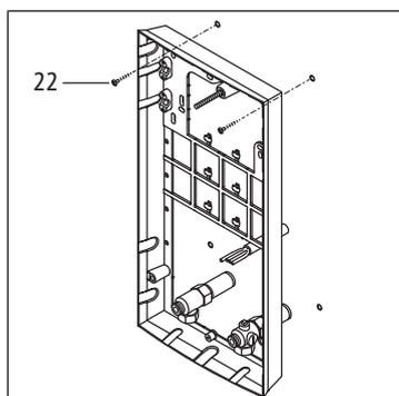
15. Fixer le cadre de montage avec les vis 4.2 x 38 mm (22) sur le mur.
