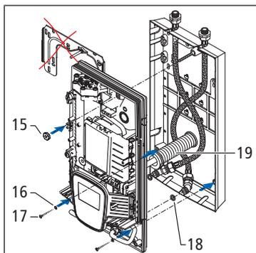
11. Fixer le boîtier sur le cadre de montage avec l'écrou moleté (15).
