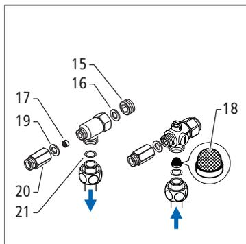
10. Monter les raccords d'eau. Alternative 3 pour les conduites d'eau posées en apparent: Visser les bouchons obturateurs (15) avec les joints (16) sur les raccords d'eau.
