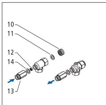
6. Monter les raccords d'eau. Alternative 2: Monter les mamelons filetés (10) sur le raccordement d'eau, ☞ «Monter les mamelons filetés», page 13.
