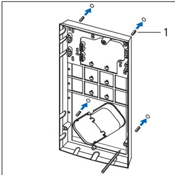
1. Marquer les orifices  $\varnothing$  6 mm et percer. Insérer les chevilles **(1)**.
