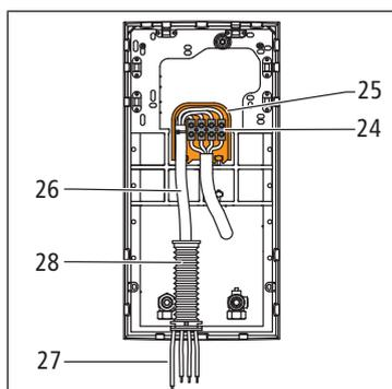
17. Réaliser le branchement électrique: placer le bloc de bornes de raccordement supplémentaire (24) dans la boîte de jonction (25). Utiliser la boîte de jonction uniquement avec l'ouverture tournée vers le bas.
