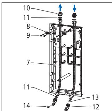
6. Fixer les tuyaux renforcés (7) avec les colliers (8) et les vis 4 x 22 mm (9) sur le cadre de montage.
