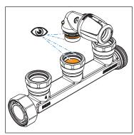
1. Examiner de visu les surfaces et le joint torique. La surface intérieure du départ du distributeur doit être propre et exempte dépôts.
