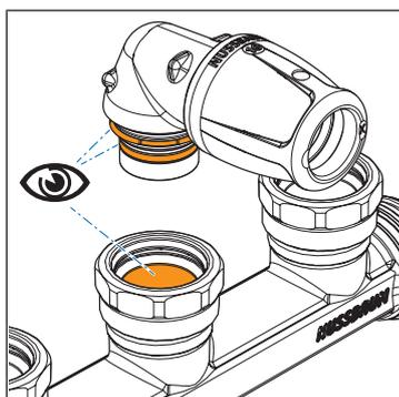
1. Examiner de visu les surfaces, le joint torique et la bague de retenue. La surface intérieure du départ du distributeur doit être propre et exempte de dépôts.
