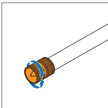
2. Ebavurer le tuyau à l'intérieur et à l'extérieur. Pour ne pas abîmer le tuyau, Nussbaum recommande l'utilisation de l'ébavureur 81096.
