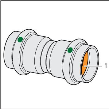
3. Vérifier que le joint **(1)** n'est pas abîmé et que l'assise au niveau de la gorge est complète. N'utiliser ni huile ni graisse.
