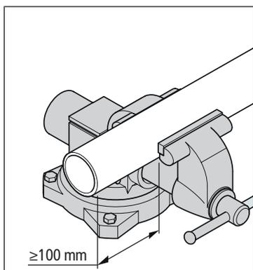
2. Serrer le tuyau dans un étau. Prévoir une longueur minimale de 100 mm entre le bout du tuyau et les mâchoires de l'étau. Ne pas déformer l'extrémité du tuyau.
