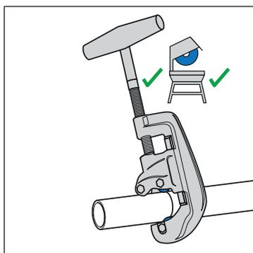
1. Couper le tuyau à angle droit avec un coupe-tuyau ou une scie à denture fine, ☞ «Tronçonnage des tuyaux», page 1.
