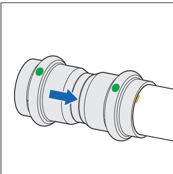
5. Engager le raccord à sertir sur le tuyau jusqu'à la butée.
