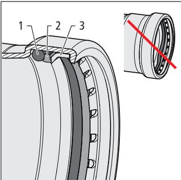
4. Vérifier que le joint **(1)**, la bague de séparation **(2)** et la bague d'ancrage **(3)** ne sont pas abîmés et que l'assise au niveau de la gorge est complète. Remplacer un raccord à sertir s'il est défectueux. N'utiliser ni huile ni graisse.
