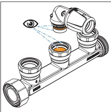
1. Effettuare un controllo visivo delle superfici e dell'O-ring. La superficie interna dell'uscita collettore deve essere pulita e priva di depositi.
