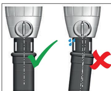
1. Montare un manicotto a innesto sul bocchettone di scarico oppure un imbuto sulla condotta di scarico.
