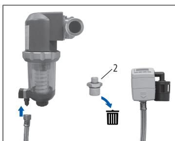
2. Collegare il tubo flessibile corazzato direttamente al filtro fine. Il collegamento **(2)** fornito in dotazione può essere smaltito non essendo necessario per i filtri fini più vecchi.
