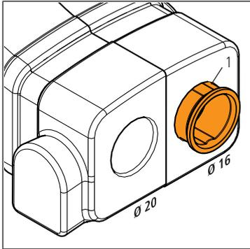
5. Inserire un tappo di riduzione **(1)** in alto e in basso per i tubi con Ø 16 mm.
