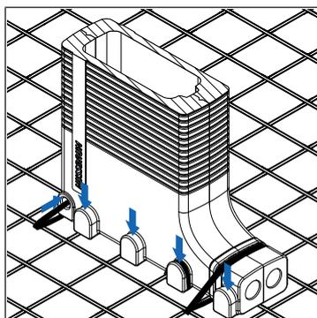
4. Fissare l'aiuto di montaggio ai punti previsti (freccia) nell'armatura inferiore con le fascette per tubi fornite in dotazione.
