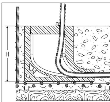
1. Misurare l'altezza del soffitto (**H**) dall'armatura inferiore.
