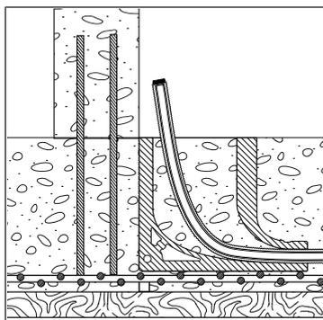
11. Riempire l'aiuto di montaggio con calcestruzzo o con rivestimento del pavimento.
