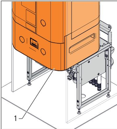
2. Far scorrere l'apparecchio di base manualmente (senza mezzi ausiliari) fino alla battuta d'arresto nei due bulloni **(2)** del sistema antiribaltamento.
