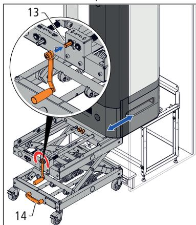
10. Inserire la manovella sull'attuatore verticale e posizionare l'apparecchio di base sullo zoccolo portante.
