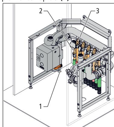
2. Collegare le condutture di distribuzione per l'acqua fredda (2) e l'acqua calda (3) ai collegamenti a innesto.
