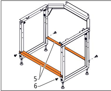
3. Apparecchio 68010: per l'installazione in armadi standard impostare l'altezza dello zoccolo portante a 480 mm.
