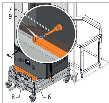
4. Estrarre i due bulloni di sicurezza (7) dai supporti (8) della piattaforma. Per fissare l'apparecchio di base all'apparecchio di sollevamento inserire i bulloni di sicurezza fino alla battuta d'arresto nei fori (9) dell'apparecchio di base.
