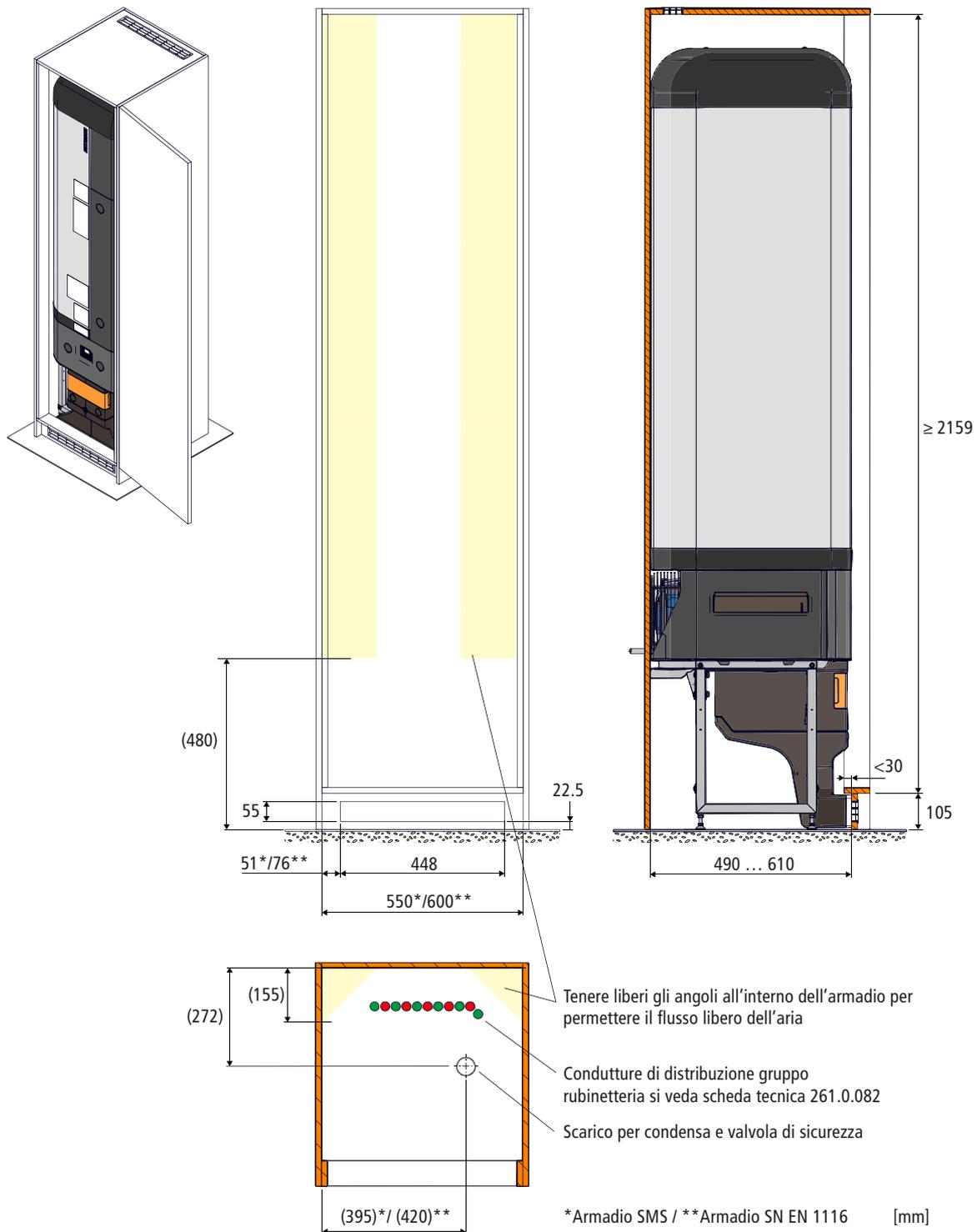
Fig. 14: Schema di posa armadio SMS / SN EN 1116:2018
