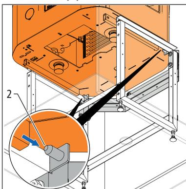
3. Per fissare l'apparecchio di base inserire le due viti a testa tonda ed esagono incassato M8 x 35 mm **(3)** nei fori **(4)** dell'apparecchio di base e avvitarle saldamente allo zoccolo portante **(5)**.
