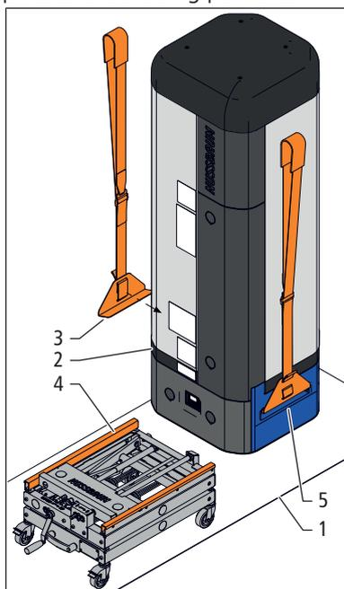
2. Utilizzando le cinghie di sollevamento (3) sollevare l'apparecchio di base (2) e posizionarlo sull'apparecchio di sollevamento (4). Per sollevare l'apparecchio di base servono almeno due persone. Regolare
