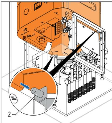
3. Per fissare l'apparecchio di base inserire le due viti a testa tonda ed esagono incassato M8 x 35 mm **(3)** nei fori **(4)** dell'apparecchio di base e avvitarle saldamente al gruppo rubinetteria **(5)**.
