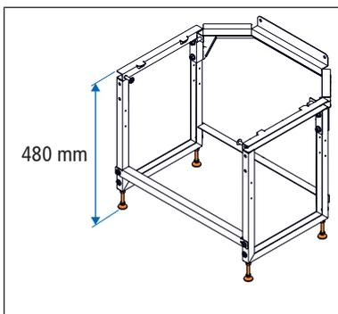
4. Opzionale: Per compensare eventuali irregolarità della pavimentazione nel luogo d'installazione, sullo zoccolo portante può essere montato il set adattatore di altezza (7) utilizzando due viti a testa tonda ed esagono incassato M8 × 16 mm per lato. **Se l'apparecchio è installato a incasso a misura non montare l'adattatore di altezza sul lato esterno dello zoccolo portante.**
