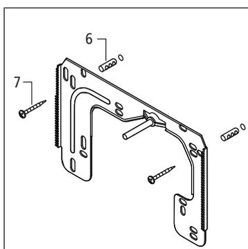
6. Inserire i tasselli **(6)** nei fori. Fissare il fissaggio murale utilizzando le viti 4.2 x 38 mm **(7)**.
