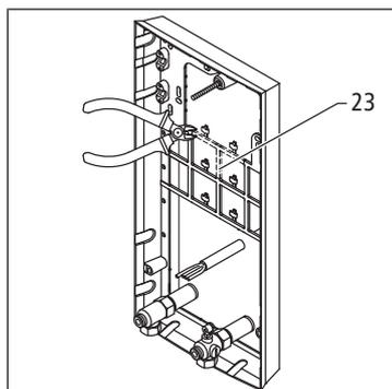
16. Rimuovere le traverse **(23)** sul telaio di montaggio come mostrato nell'immagine.
