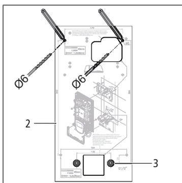
1. Tenere la dima di montaggio **(2)** contro la parete e allinearla in modo che i fori **(3)** della dima di montaggio si sovrappongano ai nippel montati.
