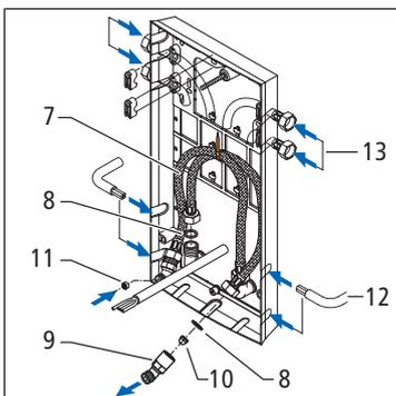
5. Avvitare i tubi flessibili corazzati (7) al gomito utilizzando le guarnizioni (8). L'immagine mostra opzioni di passaggio alternative per il cavo di collegamento (12) e per i tubi flessibili corazzati (13) con posa laterale.
