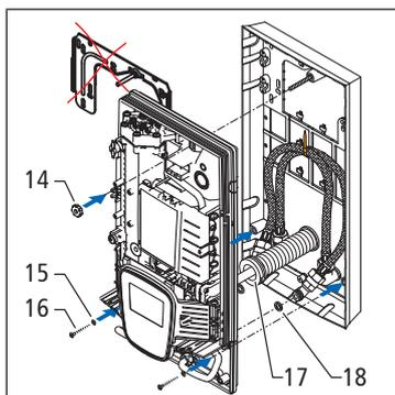
9. Fissare l'apparecchio al telaio di montaggio utilizzando il dado zigrinato **(14)**.
