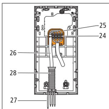
17. Realizzare il collegamento elettrico: Posizionare la morsettiera supplementare **(24)** nella scatola di raccordo **(25)**. Utilizzare la scatola di raccordo solo con l'apertura rivolta verso il basso.
