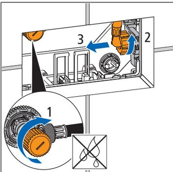
4. Sganciare la sicura dalla valvola di riempimento e sfilare la valvola di riempimento.
