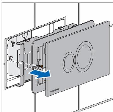
1. Sfilare la piastra di comando in avanti, svitare le viti dal telaio di base e smontare il telaio di base e l'eventuale piastra di copertura.
