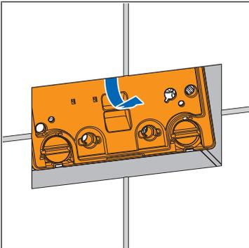
3. Chiudere la valvola ad angolo, staccare il tubo flessibile corazzato dalla valvola di riempimento e sfilare.
