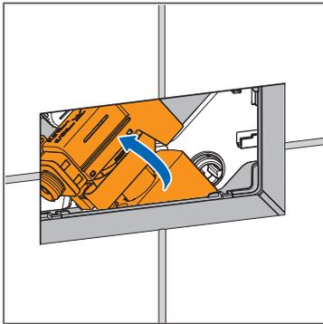
5. Ruotare la valvola di riempimento nella cassetta di scarico in modo tale che passi attraverso l'apertura d'ispezione.
