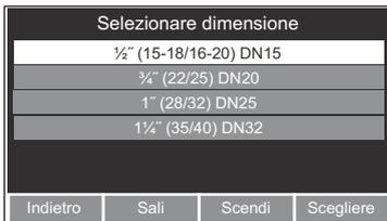
2. Con i tasti freccia selezionare la dimensione e confermare con il tasto [Scegliere]. Vengono visualizzate solo le dimensioni della valvola che consentono il montaggio dell'attuatore collegato.
