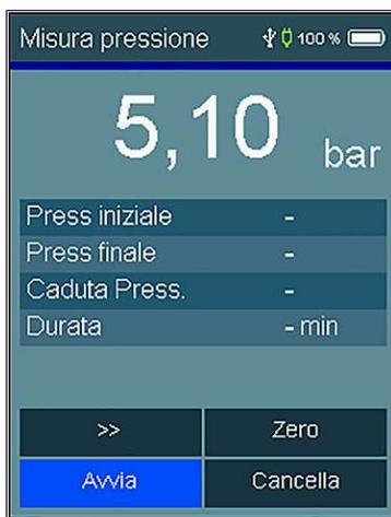
Nelle misurazioni di pressione e prove di tenuta vengono visualizzate pressione iniziale, pressione finale, perdita di pressione e durata della misurazione.
