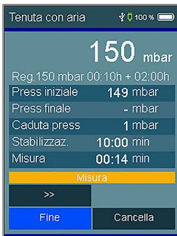
Nelle prove di tenuta viene inoltre visualizzato anche il tempo di stabilizzazione.
