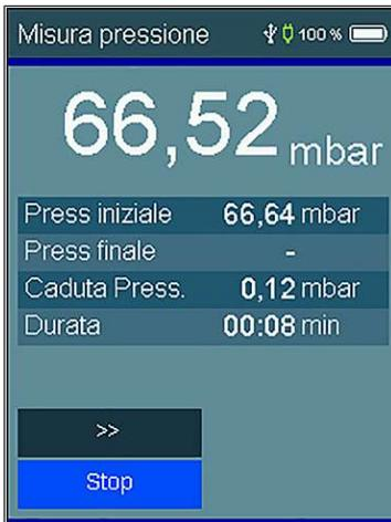
All'avvio della misurazione della pressione vengono visualizzate la pressione attuale, la pressione iniziale, la differenza rispetto alla pressione iniziale e la durata corrente della misurazione.
