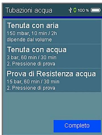
Il misuratore di pressione può essere collegato all'impianto da sottoporre a prova utilizzando i mezzi ausiliari a disposizione, ☞ «Opzioni di allacciamento», pagina 7. La pressione di prova può essere generata con qualsiasi pompa aria manuale o compressore senza olio con tubo flessibile comunemente reperibile in commercio e con raccordo per valvola Schrader. Per la misurazione ad alta pressione (3.5/25 bar) è necessario collegare il sensore di pressione esterno 83192.
