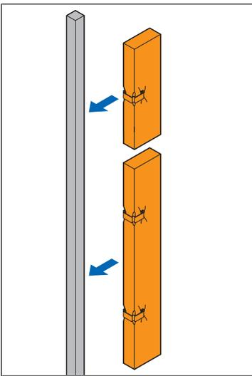
2. Den Schallabsorber mit dem bzw. den Magneten an der Optivis-Tec-Schiene befestigen.
