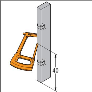
1. Den Schallabsorber bei Bedarf in der Mitte teilen. Dazu von einer Seite 40 cm abmessen.
