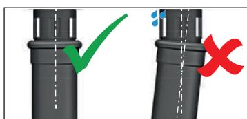
1. Die Steckmuffe am Ablaufstutzen montieren.
