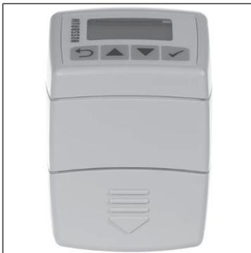
1. Das Batteriefach öffnen. Dazu die Klappe zuerst in Pfeilrichtung nach unten schieben und dann nach vorne aufklappen.
