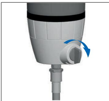
3. Den Kugelhahn des Feinfilters öffnen.
