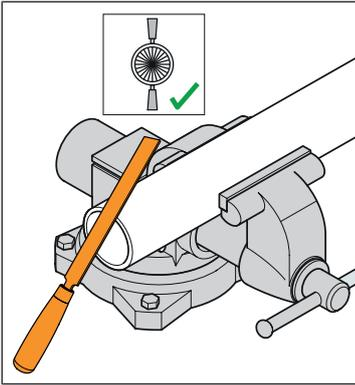
3. Das Rohr innen und aussen mit Feile oder Entgrater entgraten.
