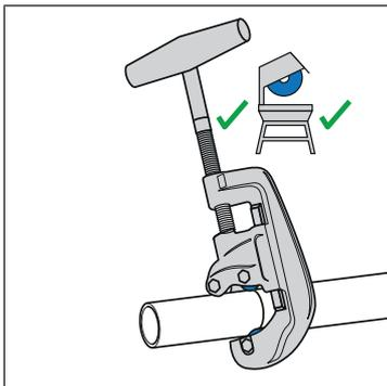
1. Das Rohr rechtwinklig mit einem Rohrabschneider oder einer feinzahnigen Säge ablängen, ☞ «Ablängen der Rohre», Seite 1.
