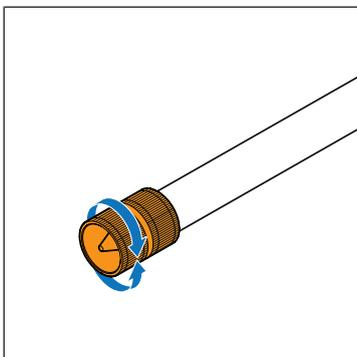
2. Das Rohr innen und aussen entgraten. Um das Rohr nicht zu beschädigen, empfiehlt Nussbaum den Rohrentgrater 81096 zu verwenden.
