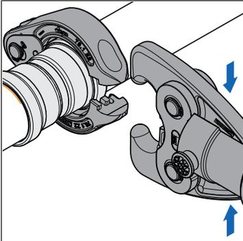
10. Die Pressbacke auf den Pressring setzen.
