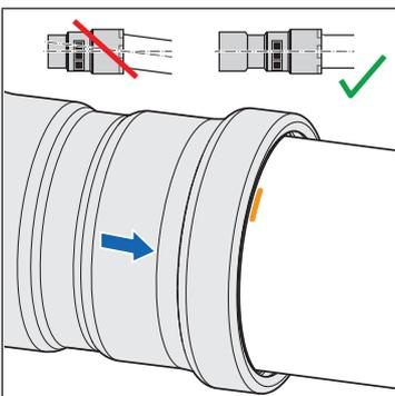
6. Den Pressfitting bis zur markierten Einstecktiefe auf das Rohr schieben. Den Pressfitting nicht verkanten.
