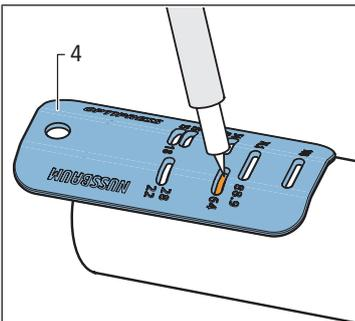
5. Die Einstecktiefe mit der Markierlehre **(4)** 57099 markieren oder mit einem Massstab **(5)** anzeichnen gemäss
