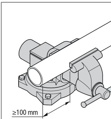
2. Das Rohr in einem Schraubstock festspannen. Mindestens 100 mm Abstand zwischen dem Rohrende und dem Schraubstock einhalten. Das Rohrende nicht verformen.
