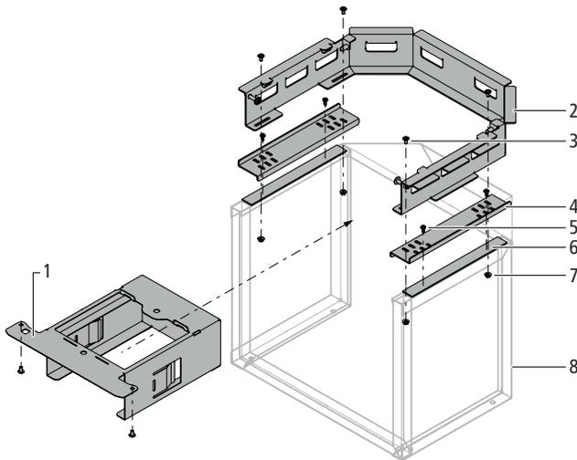
Abb. 8: Aufsatz für Fremdgestell 68022, mit Halterung für den Luftfilter
