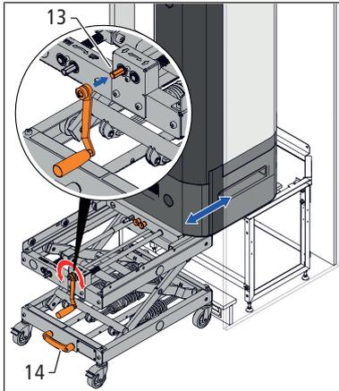
10. Die Handkurbel am Vertikaltrieb einstecken und das Grundgerät auf den Unterbau setzen.
