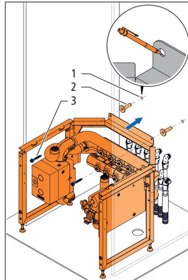
3. Die Schallschutzdübel **(2)** in die Bohrungen stecken.
