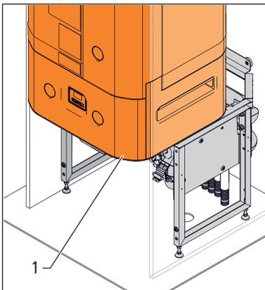
2. Das Grundgerät manuell (ohne Hilfsmittel) bis zum Anschlag in die beiden Bolzen **(2)** der Kippsicherung schieben.
