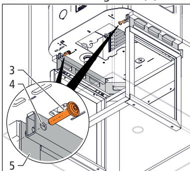
5.5.2.5 Siphon und Kondensatschlauch montieren
