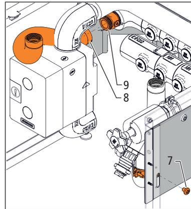
8. Sicherstellen, dass die Flachdichtung des Wellrohrs PWH **(8)** sauber ist.
