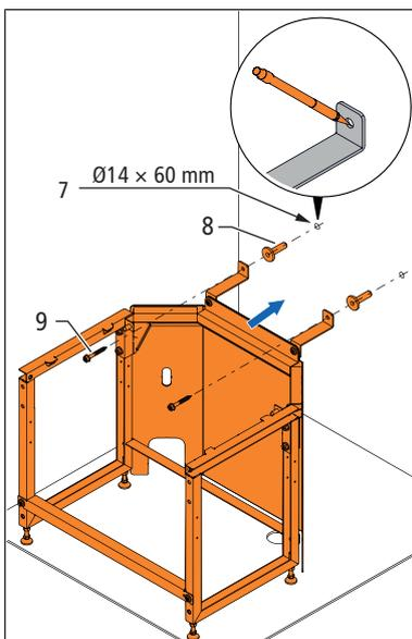
5. Die Schallschutzdübel **(8)** in die Bohrungen stecken.
