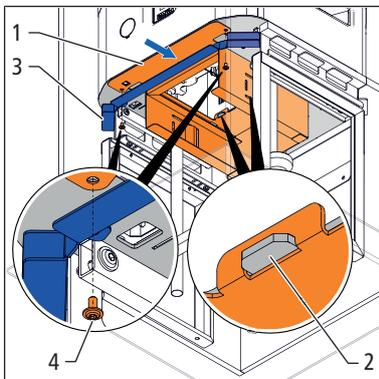
2. Den Haltebügel (3) und den Luftfilterkasten mit den beiden Innensechsrundschrauben M6 x 12 mm (4) am Gerät festschrauben.
