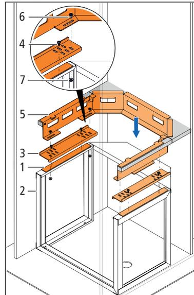
3. Die optionalen Justierplatten **(3)** auf dem Fremdgestell ausrichten und mit den Blechschrauben **(4)** befestigen. Die Justierplatten sind bei Atlantic- und Domotec-Gestellen erforderlich. Bei Elcalor-Gestellen sind keine Justierplatten erforderlich. Den Aufsatz für das Fremdgestell **(5)** mit den Innensechsrundschrauben M6 x 12 mm **(6)** und Muttern M6 **(7)** an den Justierplatten festschrauben.
