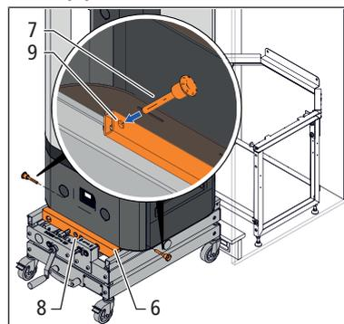
4. Die beiden Sicherungsbolzen (7) aus den Halterungen (8) an der Plattform ziehen. Um das Grundgerät am Hubwagen zu befestigen, die Sicherungsbolzen bis zum Anschlag in die Bohrungen (9) am Grundgerät einstecken.
