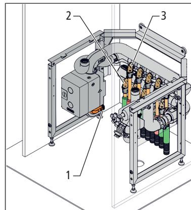
2. Die Verteilungen für Kaltwasser **(2)** und Warmwasser **(3)** an den Steckübergängen anschliessen.
