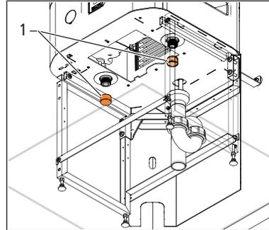
2. Die Rohrleitungen durch die Öffnungen im Heckteil der Unterbau-Abdeckung zu den Wasseranschlüssen unter dem Gerät führen.
