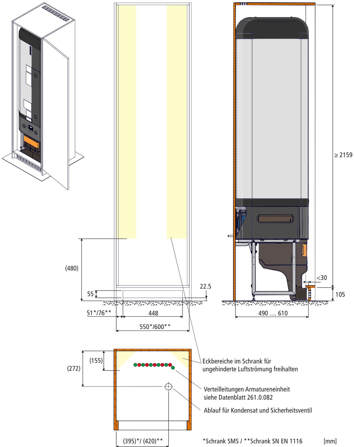
Abb. 23: Einlegeschema Schrank SMS / SN EN 1116:2018
