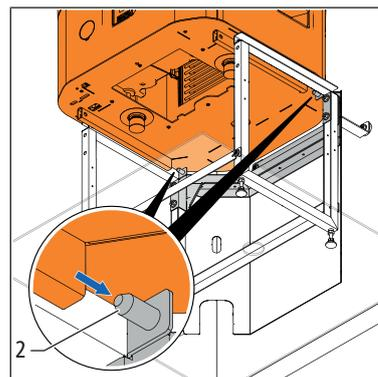
3. Um das Grundgerät zu befestigen, die beiden Innensechsrundschrauben M8 × 35 mm **(3)** durch die Bohrungen **(4)** am Grundgerät führen und am Unterbau **(5)** festschrauben.
