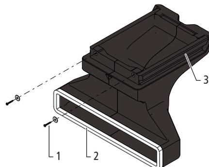
Abb. 11: Luftführung Zuluft 68014
