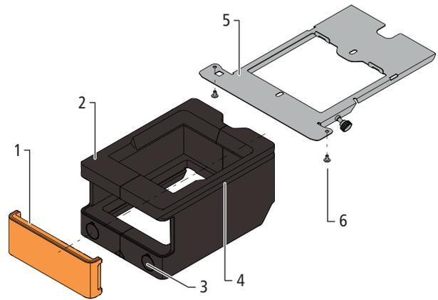
Abb. 10: Luftfiltergehäuse (ohne Luftfilter) 68013 und Führungsschiene 68967
