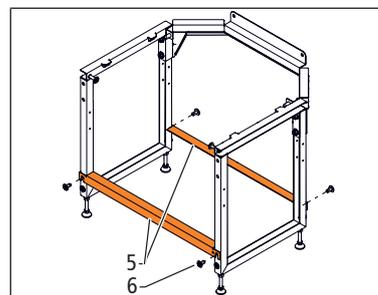
3. Gerät 68010: Für den Einbau in Normschränke die Unterbauhöhe auf 480 mm einstellen.
