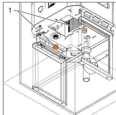
2. Sicherstellen, dass die Flachdichtungen sauber sind.
