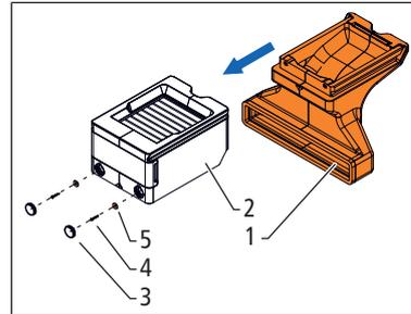
2. Die Blinddeckel (3) am Luftfiltergehäuse entfernen.
