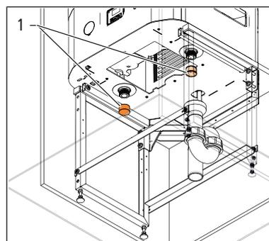
2. Sicherstellen, dass die Flachdichtungen sauber sind.
