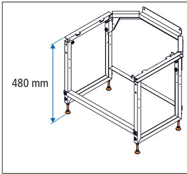
4. Optional: Um Bodenunebenheiten am Aufstellort auszugleichen, kann das Höhenadapter-Set (7) mit jeweils 2 Innensechsrundsrauben M8 x 16 mm am Unterbau montiert werden. **Bei passgenauem Schrankeinbau die Höhenadapter nicht an der Aussenseite des Unterbaus montieren.**
