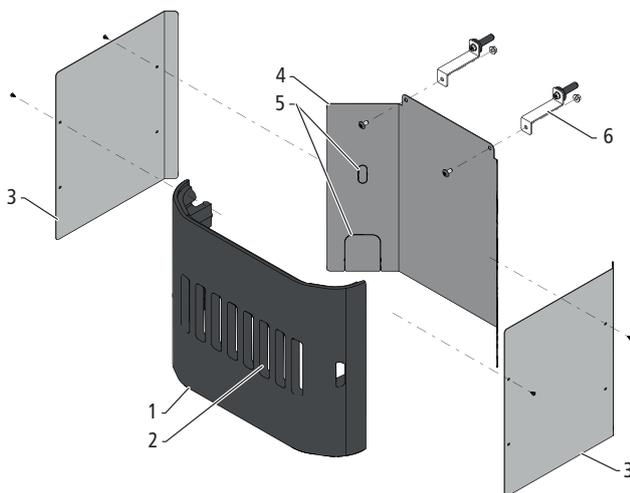
Abb. 13: Unterbau-Abdeckung 68031
