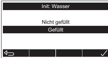
⇒ Das Gerät prüft den Füllstand des Speichers. Anschliessend wird die Betriebsart [Workzone] aktiviert. Bei ungenügendem Füllstand erscheint eine Fehlermeldung.
