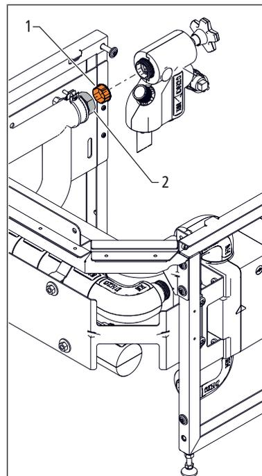
2. Sicherstellen, dass der Übergang **(3)** der Sicherheitsgruppe und die Schnellkupplung frei von Verunreinigungen und Beschädigungen sind.
