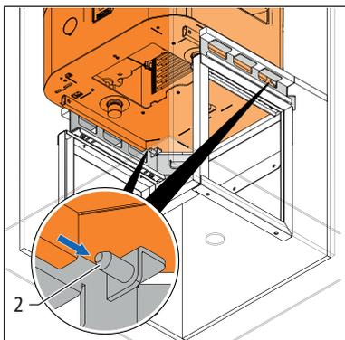
3. Um das Grundgerät zu befestigen, die beiden Innensechsrundschrauben M8 x 35 mm **(3)** durch die Bohrungen **(4)** am Grundgerät führen und am Aufsatz für das Fremdgestell **(5)** festschrauben.
