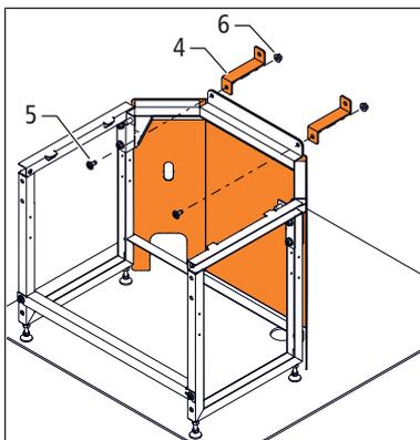
3. Den Unterbau mithilfe einer Wasserwaage nivellieren.
