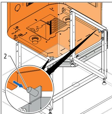
3. Um das Grundgerät zu befestigen, die beiden Innensechsrundsrauben M8 x 35 mm **(3)** durch die Bohrungen **(4)** am Grundgerät führen und am Unterbau **(5)** festschrauben.
