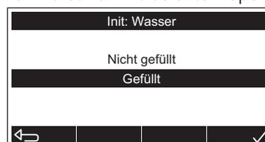
⇒ Das Gerät prüft den Füllstand des Speichers. Anschliessend wird die Betriebsart [Workzone] aktiviert. Bei ungenügendem Füllstand erscheint eine Fehlermeldung.
