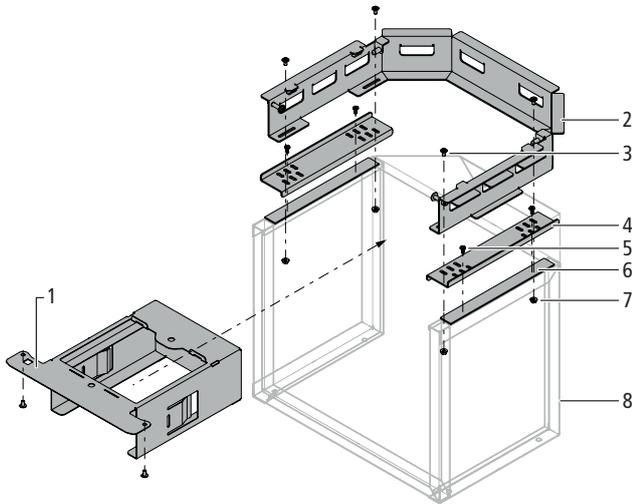
Abb. 4: Aufsatz für Fremdgestell 68022, mit Halterung für den Luftfilter
