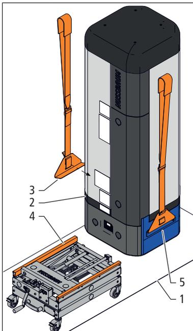
2. Das Grundgerät (2) mithilfe der Traggurte (3) auf den Hubwagen (4) heben. Zum Heben des Grundgeräts sind mindestens 2 Personen erforderlich. Die Traggurte in der Länge an die Körpergröße der Person anpassen. Den Traggurt über den Kopf auf die Schulter legen. Die Traggurte in den Griffen (5) am Grundgerät anschlagen und das Grundgerät mit
