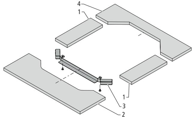
Abb. 6: Kammer-Abdichtung 68021, mit dem Haltebügel
