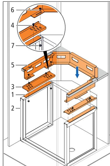
3. Die optionalen Justierplatten **(3)** auf dem Fremdgestell ausrichten und mit den Blechschrauben **(4)** befestigen. Die Justierplatten sind bei Atlantic- und Domotec-Gestellen erforderlich. Bei Elcalor-Gestellen sind keine Justierplatten erforderlich. Den Aufsatz für das Fremdgestell **(5)** mit den Innensechsrundschräuben M6 x 12 mm **(6)** und Muttern M6 **(7)** an den Justierplatten festschrauben.
