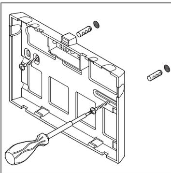
1. Die Bohrungen anzeichnen und bohren.
