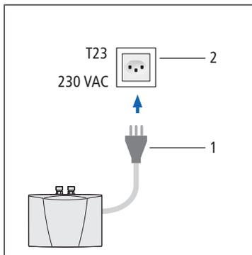
1. Den Netzstecker **(1)** des Anschlusskabels in eine Netzsteckdose T23 **(2)** stecken. Der Schutzleiter muss angeschlossen sein.
