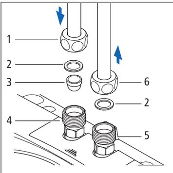
Die Wasserleitungen müssen spannungsfrei am Gerät angeschlossen werden.
