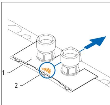
1. Die Haubenblende **(1)** an der Riffelung **(2)** in Richtung der Wandhalterung unter die Wasseranschlussstücke schieben.
