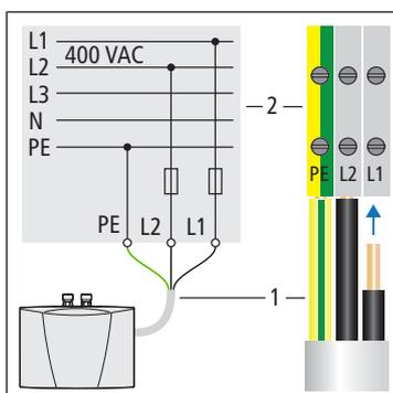
1. Den Schutzleiter und die beiden Aussenleiter des Anschlusskabels **(1)** an die Anschlussklemmen der Hausinstallation **(2)** anschliessen.
