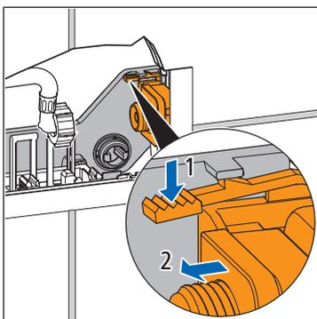
4. Die Sicherung am Füllventil lösen und das Füllventil wegziehen.
