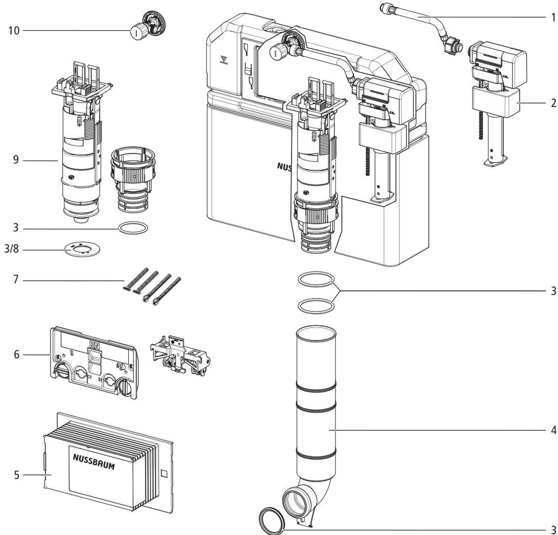
Abb. 2: Ersatzteile UP-Spülkästen, Bauhöhe 840 bis 980 mm, Modellreihe ab 2023
