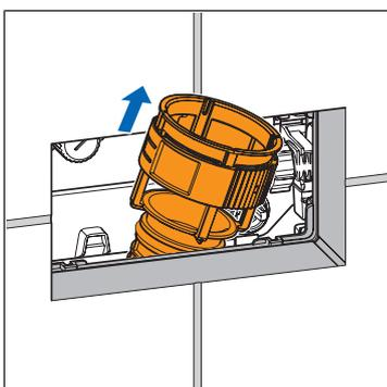
4. Die Spülstromdrossel durch die Revisionsöffnung entnehmen.
