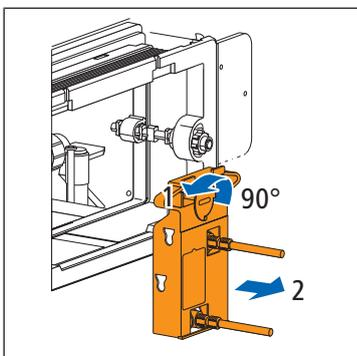
4. Die Mechanik mit dem Schraubenzieher entlasten (90° nach links drehen) und herausziehen.
