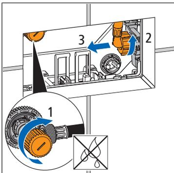
3. Das Eckventil schliessen und den Panzerschlauch am Füllventil lösen und abziehen.
