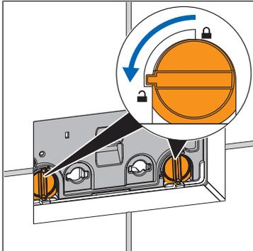
1. Die Verriegelung der Grundplatte um 90° gegen den Uhrzeigersinn drehen.
