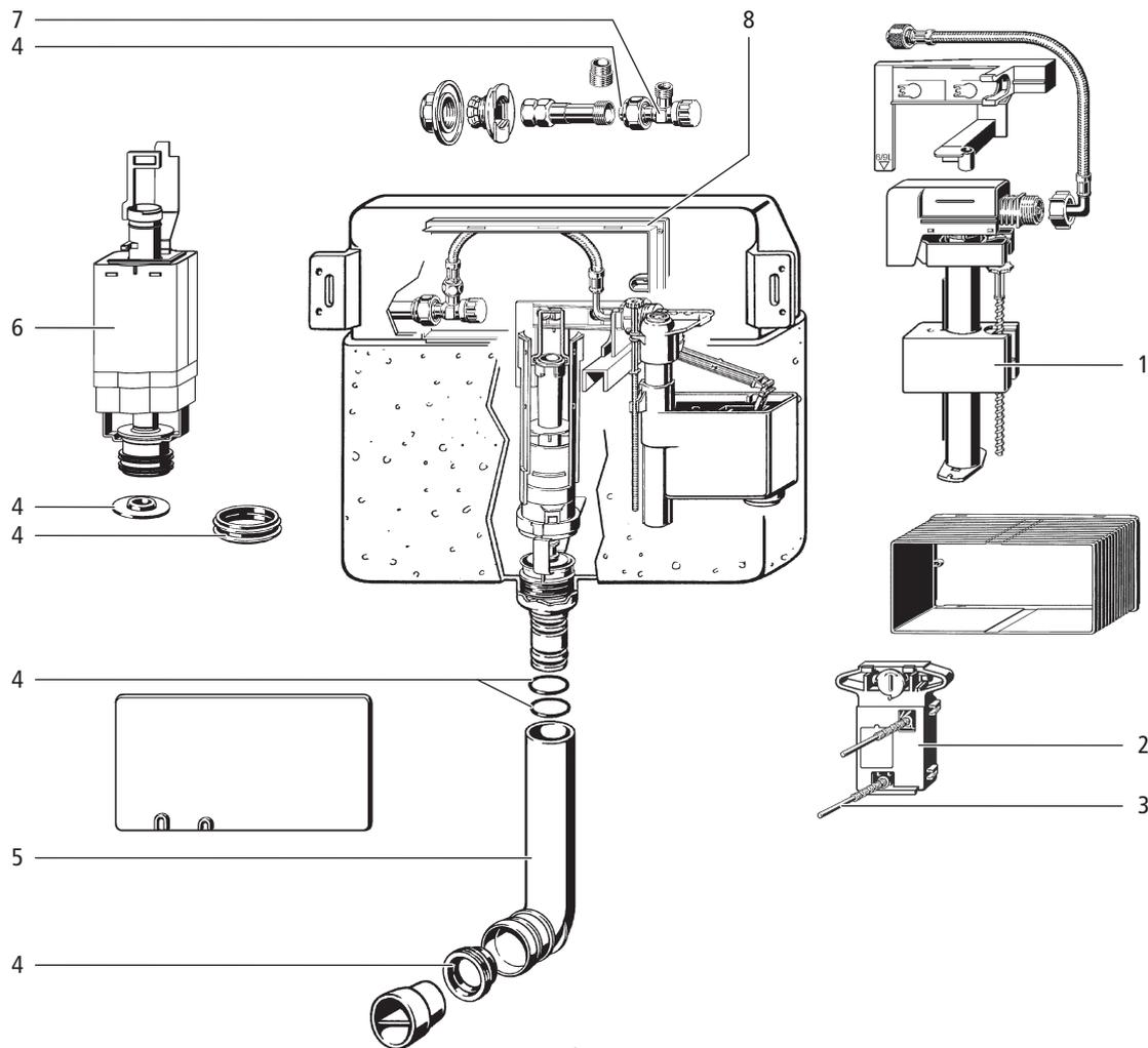
Abb. 4: Ersatzteile UP-Spülkasten, Bauhöhe 980 bis 1130 mm, Modellreihe 2000 bis 2008
