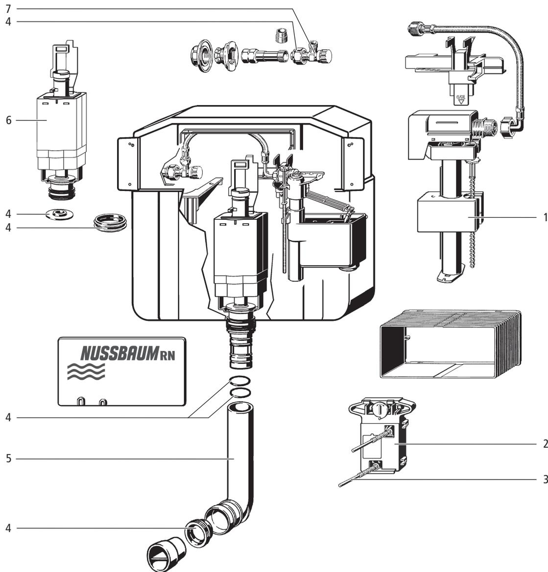
Abb. 3: Ersatzteile UP-Spülkasten, Bauhöhe 980 bis 1130 mm, Modellreihe 2009 bis 2022
