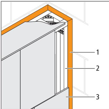
2. Die Schnittkanten der Gipskartonplatten auf 2/3 der Plattenstärke im Winkel von ca. 45° anfasen.
