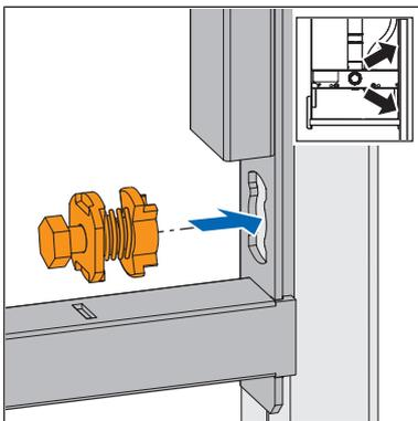
2. Den Nutenstein eindrücken, bis er hörbar einrastet und anschliessend um 90° im Uhrzeigersinn drehen.
