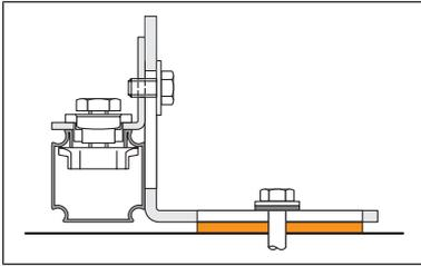
6. Die Schienen mit Hilfe von Montagewinkeln auf dem Boden befestigen.
