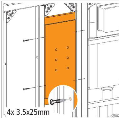
3. Die Gipskartonplatten mit Selbstbohrschrauben an der Holzplatte befestigen.
