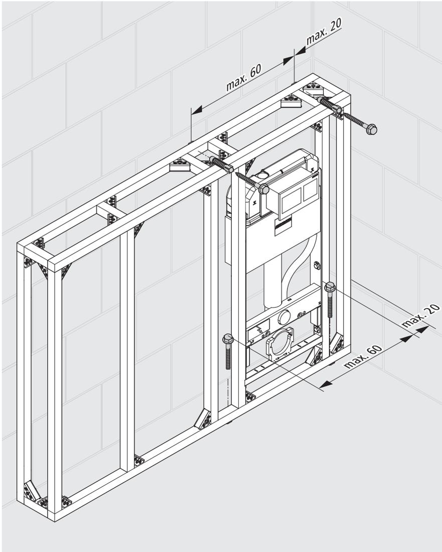
Abb. 9: Befestigungspunkte für WC-Modul in teilhoher Vorwand
