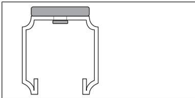
10. Das Schalldämmelement auf der Innenseite der Schiene anbringen.
