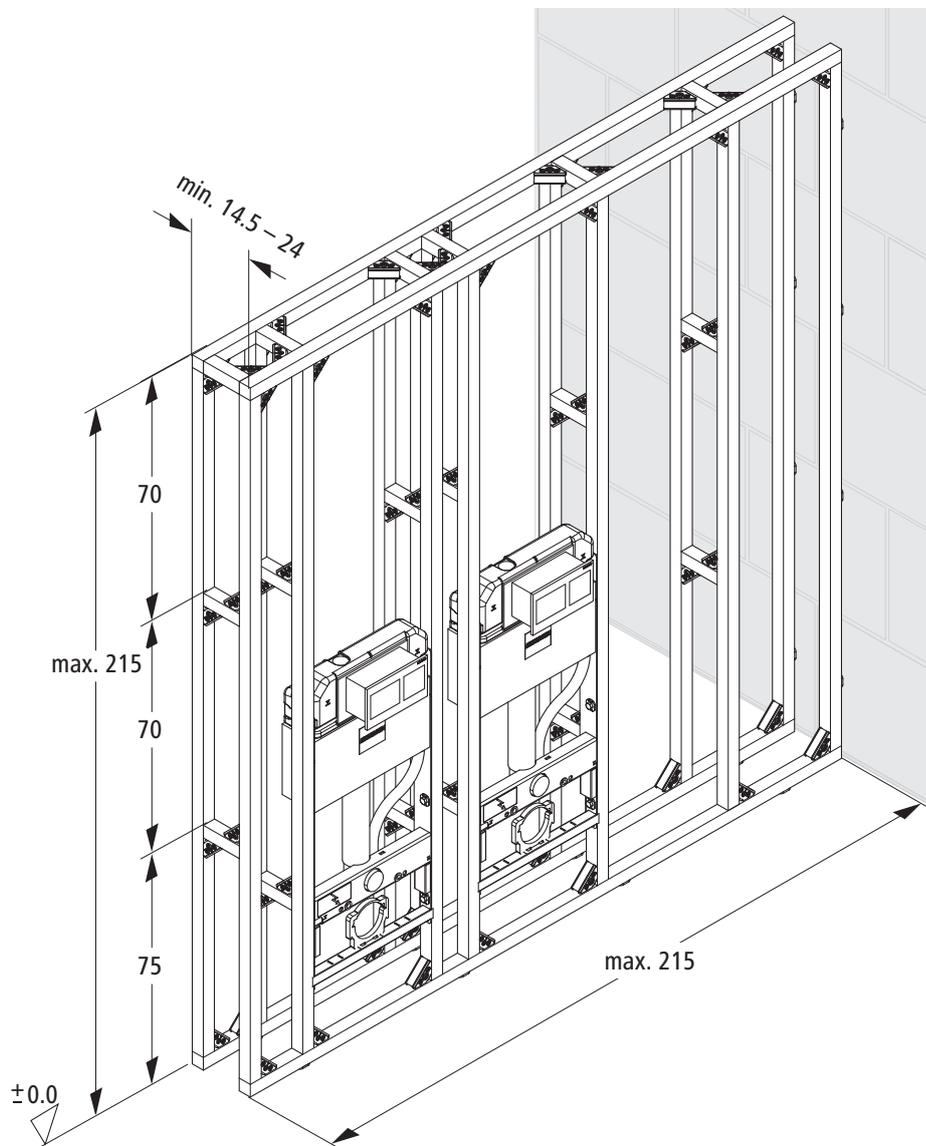
Abb. 14: Montagemasse Flügelwand 24 cm × 215 cm × 215 cm, beplankt
