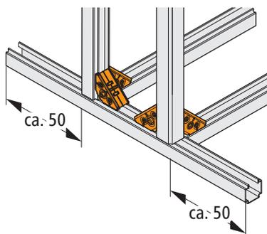
Abb. 27: Aufbau mit verlängerter Schiene als Kippschutz
