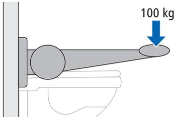
Abb. 29: Belastung Stützklappgriff
