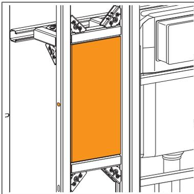
1. Die Vorwandkonstruktion mit einer zusätzlichen Wandschiene max. 40 cm unter der Holzplatte verstärken.
