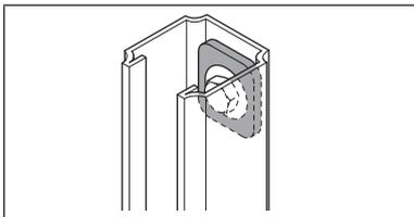
12. Die Schienen mit dem beiliegenden Befestigungsmaterial direkt an der Wand oder auf dem Boden anbringen.
