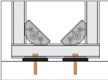
2. Die Ecken der Bodenschienen mit jeweils 2 Verbindern stabilisieren.
