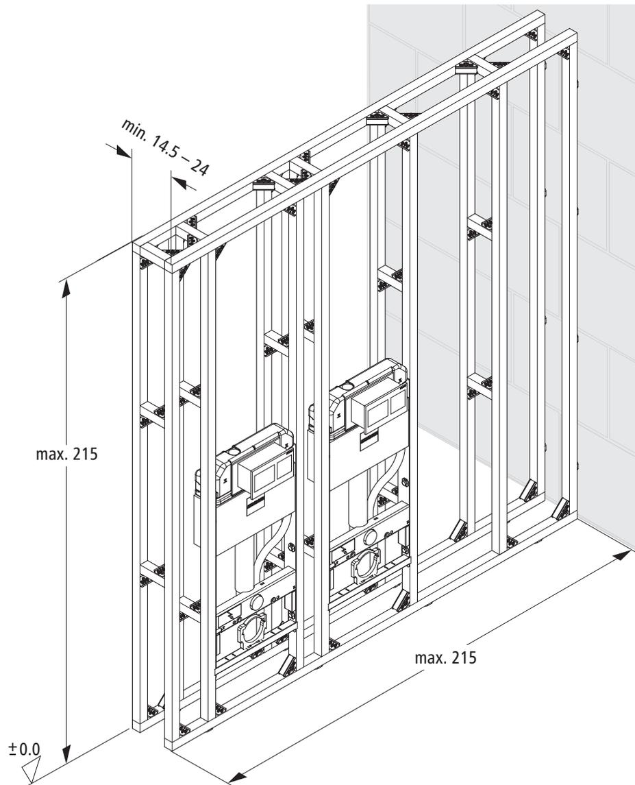
Abb. 3: Einbaumasse Flügelwand 24 cm × 215 cm × 215 cm, beplankt
