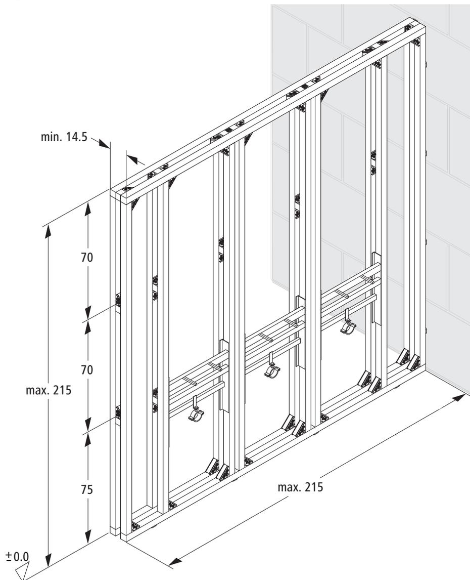
Abb. 15: Montagemasse Flügelwand 14.5 cm × 215 cm × 215 cm, beplankt
