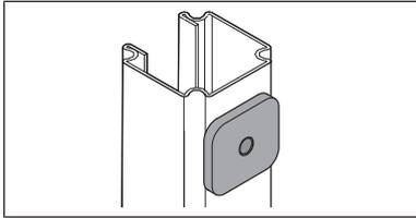
9. Dafür den Kragen des Schalldämmelements an der Schienenrückseite in das vorgestanzte Loch stecken.
