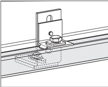
7. Bodenschiene ausrichten.
