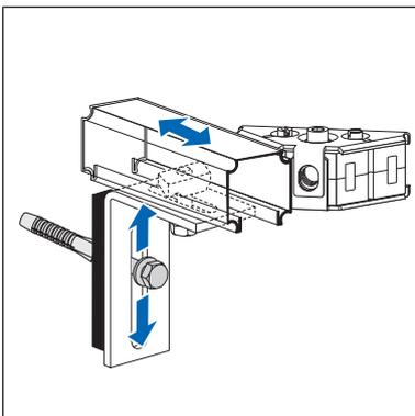
10. Bei kleinen Unebenheiten an Wänden oder Bodenbelägen Distanzplatten unter den Befestigungspunkt schieben. Die Anzahl der Distanzplatten an die Höhe der Unebenheit anpassen.
