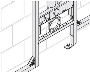
Abb. 35: Befestigung des Moduls mit einem Montagewinkel bei Unterbrechung der Bodenschiene
