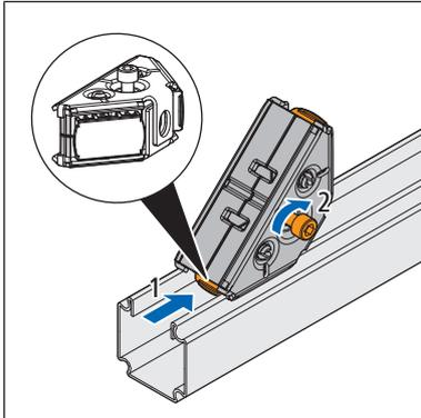
3. Die Befestigungsschraube mit einem Innensechskantschlüssel anziehen.
