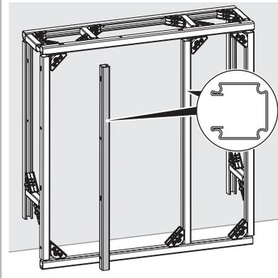
1. Mit den beiliegenden Nutensteinen das Modul auf der offenen Optivis-Tec-Schiene befestigen, dazu den Nutenstein in die Öffnung des Moduls einstecken.
