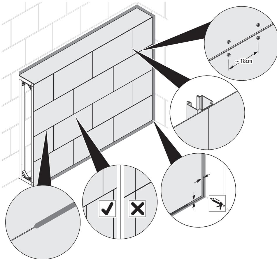
Abb. 30: Verarbeitungsregeln Beplankung horizontal
