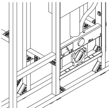
Abb. 37: Zusätzliche Schiene zur Verbindung beider Seiten
