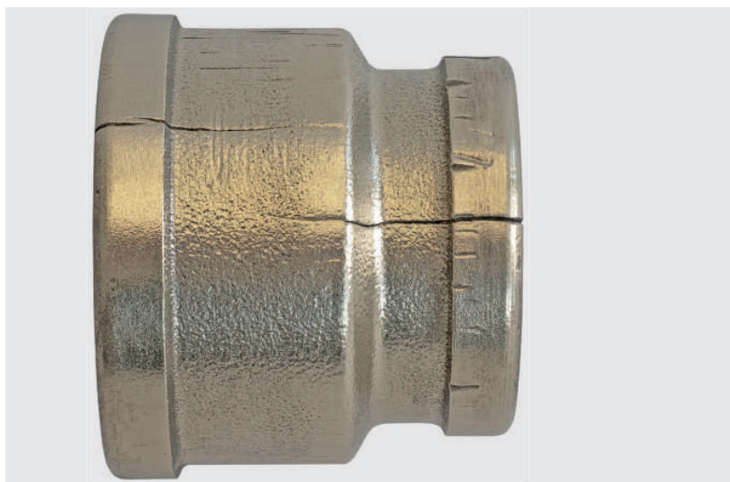
Fig. 18: Immagine del danno dovuto a tensocorrosione su un raccordo filettato.
