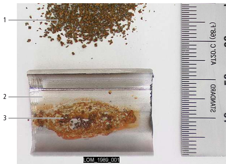
Abb. 38: Korrosion von Metallspänen in einem Edelstahlrohr
